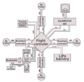
Fig. 12: THE QUADROTORS EXTENDED FUNCTIONAL DIAGRAM. THE FLIGHT CONTROL BOARD UTILIZES THE SENSORS DATA AND COMPUTES THE CONTROL SIGNAL FOR THE BRUSHLESS CONTROLLERS. COMMUNICATION BETWEEN THEM AND THE GUMSTIX COMPUTER IS ESTABLISHED VIA 12C BUS. THE SIGNAL LEVEL TRANSLATOR SERVES FOR NORMALIZING DIFFERENT VOLTAGE LEVELS OF DATA SIGNALS.
