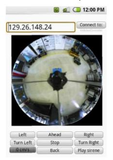
Fig. 9: USER INTERFACE OF TELEOPERATOR SOFTWARE IN THE ANDROID ENVIRONMENT.
